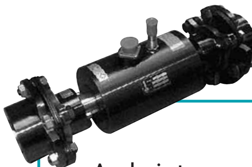
Acoplamiento transductor de par El acoplamiento espaciador especial tiene un transductor de par incorporado para utilizar en aparatos de pruebas. El dispositivo se utiliza para probar transmisiones de vehículos todo terreno.
